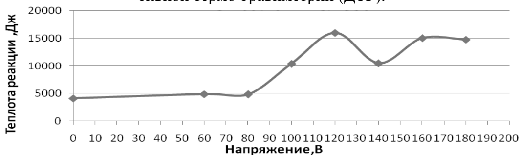
Рисунок 5. Изменение количества выделяющейся энергии в зависимости от напряжения на реакторе.
